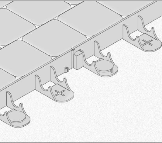
**PL** Aby obrzeże było całkowicie niewidoczne, należy umieścić je około 4,5 cm ponizej poziomu gruntu, trawnika i zasypać korą, ziemią, grysem.
